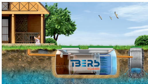
Самотечный отвод очищенных стоков в дренажный колодец
