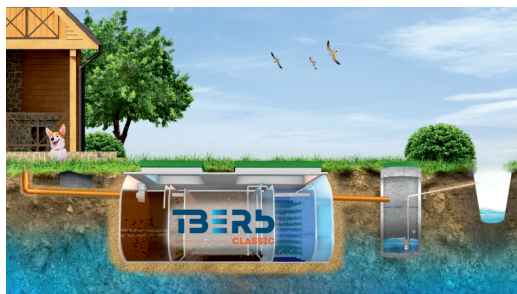
Самотечный отвод стоков в канаву или кювет
