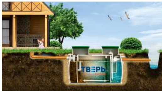
Самотечное отведение в дренажную канаву.
