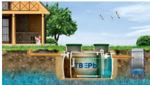
Самотечное отведение в приемный дренажный колодец.
