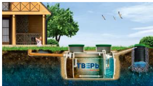
Принудительное отведение в дренажный колодец "Альпийская горка".
